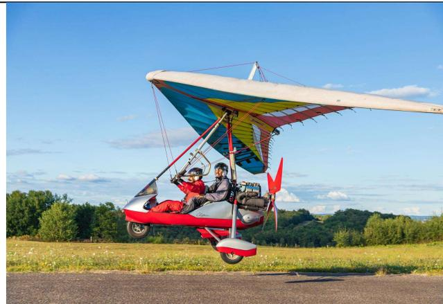
Un ULM pendulaire est un aéronef sustenté par une voile rigide sous laquelle est accroché un chariot motorisé. La puissance est inférieure ou égale à 82 CV. pour les monoplaces et 102 cv. pour les biplaces. La vitesse minimum de vol est inférieure ou égale à 65 km/h.
