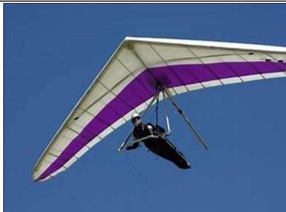
L'aile delta est un planeur ultra léger, monoplace ou biplace, possédant une armature rigide et une toile en forme de delta, dont le décollage et l'atterrissage se font à pied
