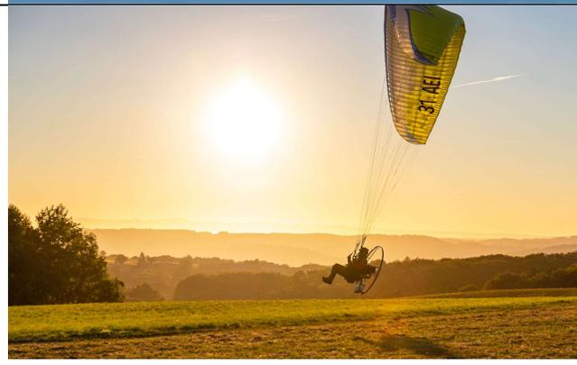
Un ULM paramoteur est un aéronef sustenté par une voile souple, de type parachute. La puissance est inférieure ou égale à 82 CV. pour les monoplaces et 102 cv. pour les biplaces. La vitesse minimum de vol est inférieure ou égale à 65 km/h.
