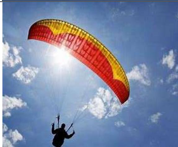
Le parapente est un aéronef à voile souple composée de caissons dans lesquels l'air s'engouffre afin de lui donner sa forme, dont le décollage et l'atterrissage se font également à pied.
