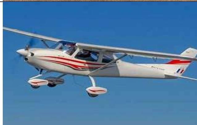
Un ULM multiaxe est un aéronef sustenté par une voile fixe. La puissance est inférieure ou égale à 88 CV. pour les monoplaces et 109 CV. pour les biplaces. La vitesse de décrochage est inférieure ou égale à 70 km/h.
